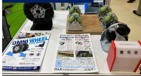
全方向に軽い力で移動・旋回できる特殊ホイール(オムニホイール)他、同ホイールの装着により走行時に最も負荷が高い「初期動作」での負荷を低減させた電動車いすを展示。
