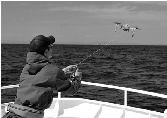
図2. RALによるドローン回収の様子。回収員が紐を手繰ってドローンを引き寄せる。
