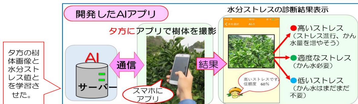
図1 開発したAIアプリの仕組みと診断結果
