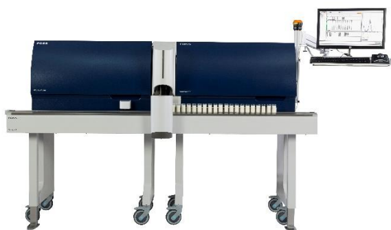
写真 ミルク分析装置 (脂肪酸組成を含む乳成分を分析)
