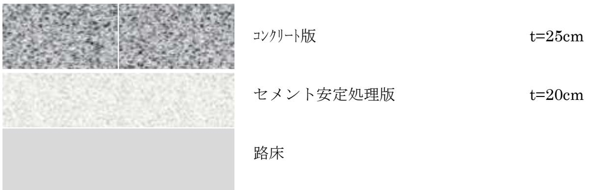
付図 1.1.4.2 転圧コンクリート舗装の断面例 (N5 交通、CBR=4)
