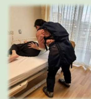
介護ロボット(アシストスーツ)を用いた介助の様子
