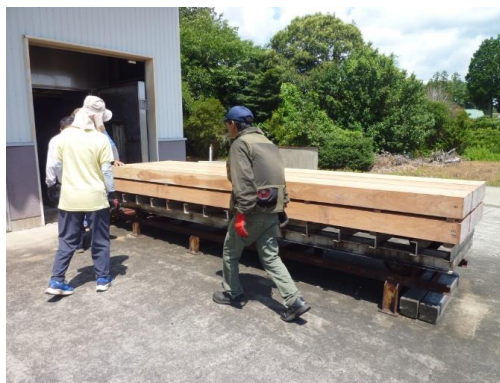
写真-2. スギ芯持ち平角材の人工乾燥試験
