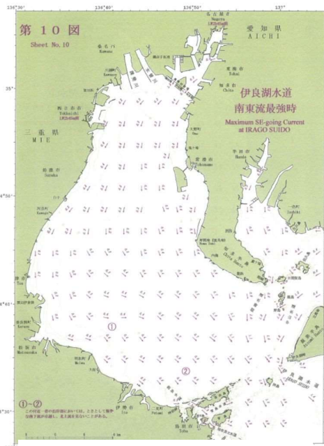
潮流図（伊良湖水道南東流最強時）
