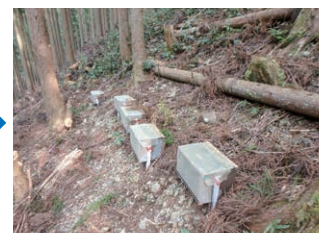
土砂受け箱を設置し、 土砂流亡量を継続調査
