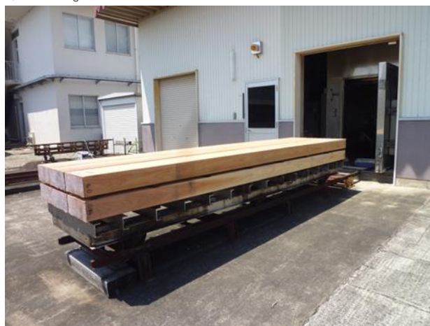
平角材の乾燥試験
