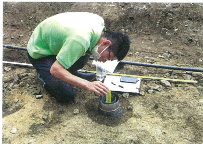
雨庭の浸透能力を測定する高田研究員。浸透能力をどのように向上させるかが流域治水のキーを握る
