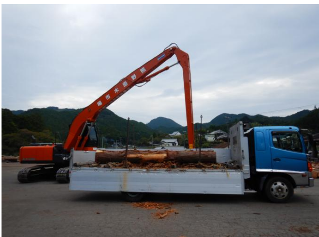
グラップルクレーンの「荷下ろし」状況
