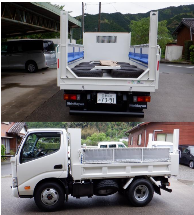
3t高床ダンプトラック4WD(後部と側部)
