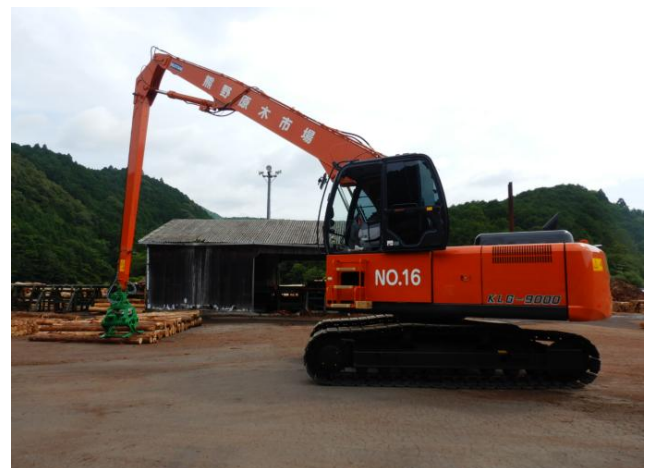
グラップルクレーンの「はい積」状況
