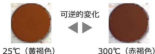
図1 温度変化に伴う色彩変化の例（マグネシウムを添加したフェライト）
