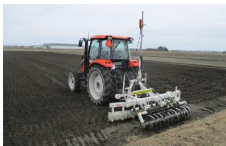
レーザーレベラーによる圃場の均平処理
